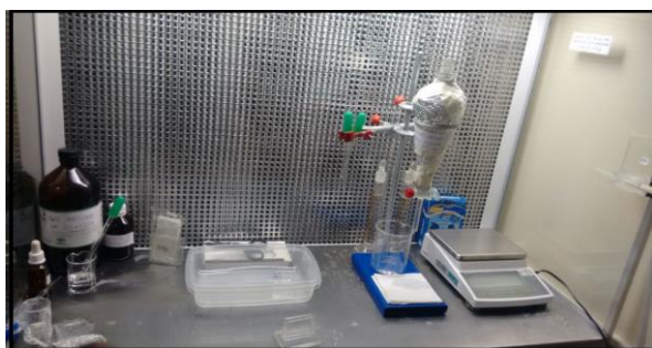
Figura 4 - Cabine de fluxo laminar horizontal (ambiente isento de poeira) com o funil de separação contendo a solução Fricke.
