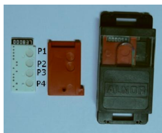
Figura 1. Composición de un dosímetro albedo. De izquierda a derecha: slide, porta slide y dosímetro completo con cover albedo. Pueden observarse cristales en las 4 posiciones del slide.
