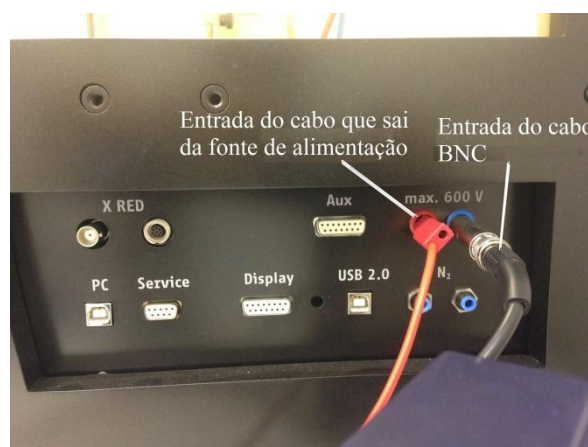
Figura 4: Conexões no aparelho de raios X vindas do amplificador e da fonte de alimentação.
