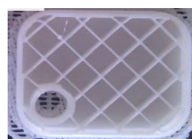
Figura 4. Modo de preenchimento da placa de PLA impressa [Adaptado de UP! User Manual]
