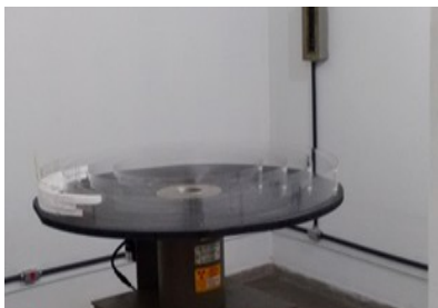
Figura 3. Irradiador Panorâmico de ^{137}\text{Cs} Hopewell.
